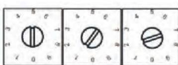
Рисунок 3 - Пример задания режима регулирования температуры  $T=51^{\circ}\text{C}$ , период регулирования - 32 сек
