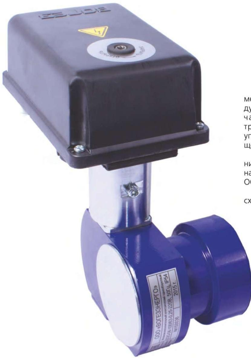
Электрические исполнительные механизмы (ЭИМ) оснащены ручным дублером и двумя концевыми выключателями. Схема подключения: трехпроводная (трехпозиционное управление). Напряжение управляющего сигнала: ~220 В, 50 Гц.
