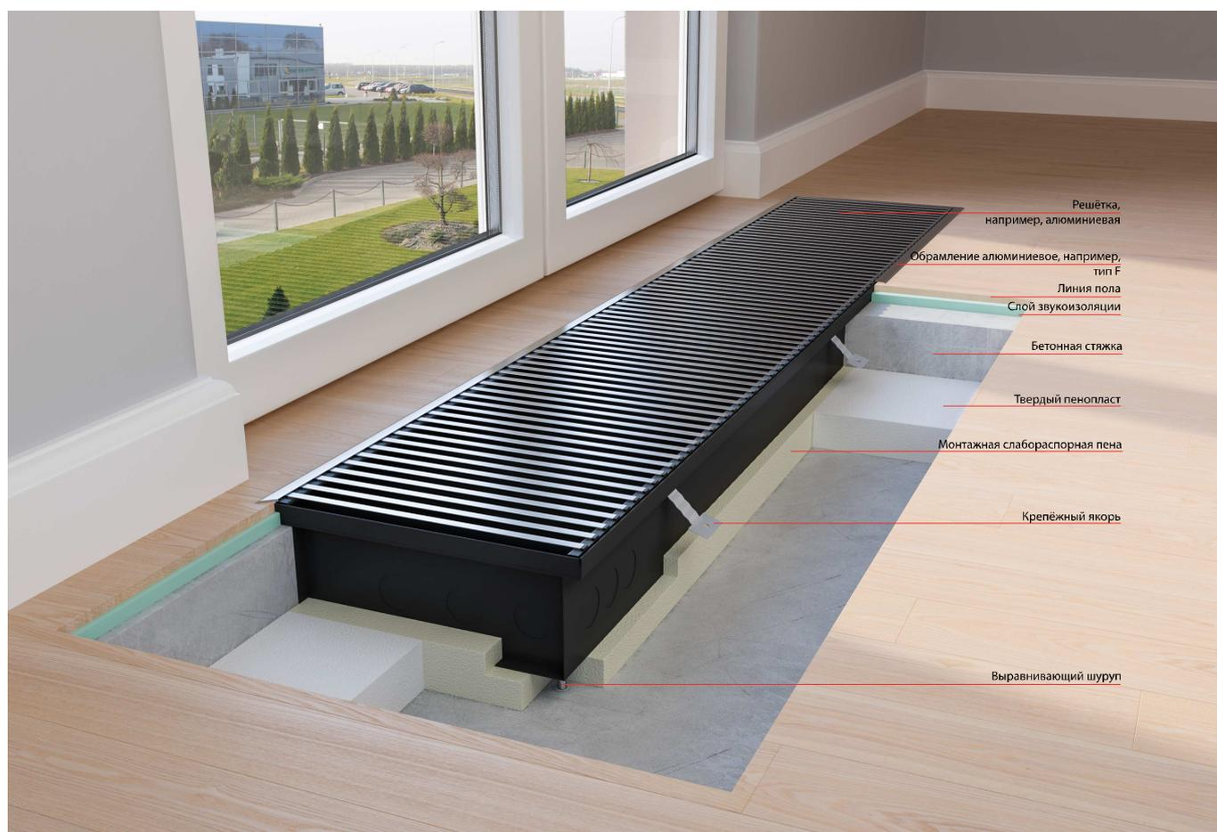
*Пример монтажа неглубокого внутрипольного конвектора*
