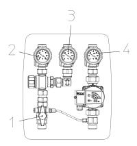
После удаления накидных гаек можно снять термостатический смеситель. При монтаже нового смесителя используйте только новые температуроустойчивые уплотнения. После замены термостатического смесителя все шаровые краны снова полностью открыть.
