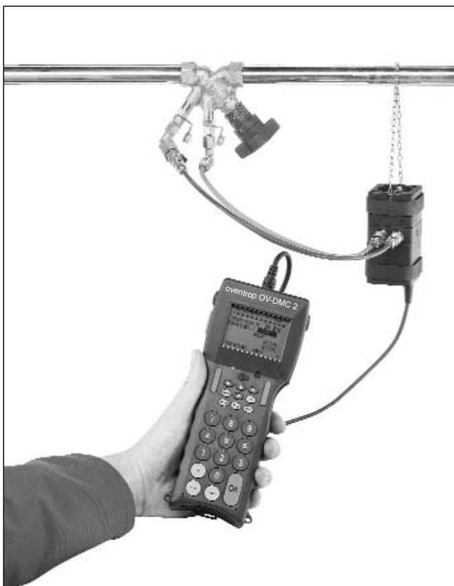
„OV-DMC 2“ арт. № 106 91 77 с регулирующим вентилем „Hydrocontrol R“
